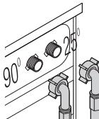
Подсоедините специальные водопроводные шланги, которые входят в комплект, к водоприемным патрубкам стиральной машины. Красный шланг (слева) (макс. 90 °C) подсоединяется к патрубку для горячей воды, а синий (справа) (макс. 25 °C) – к патрубку для холодной воды.
